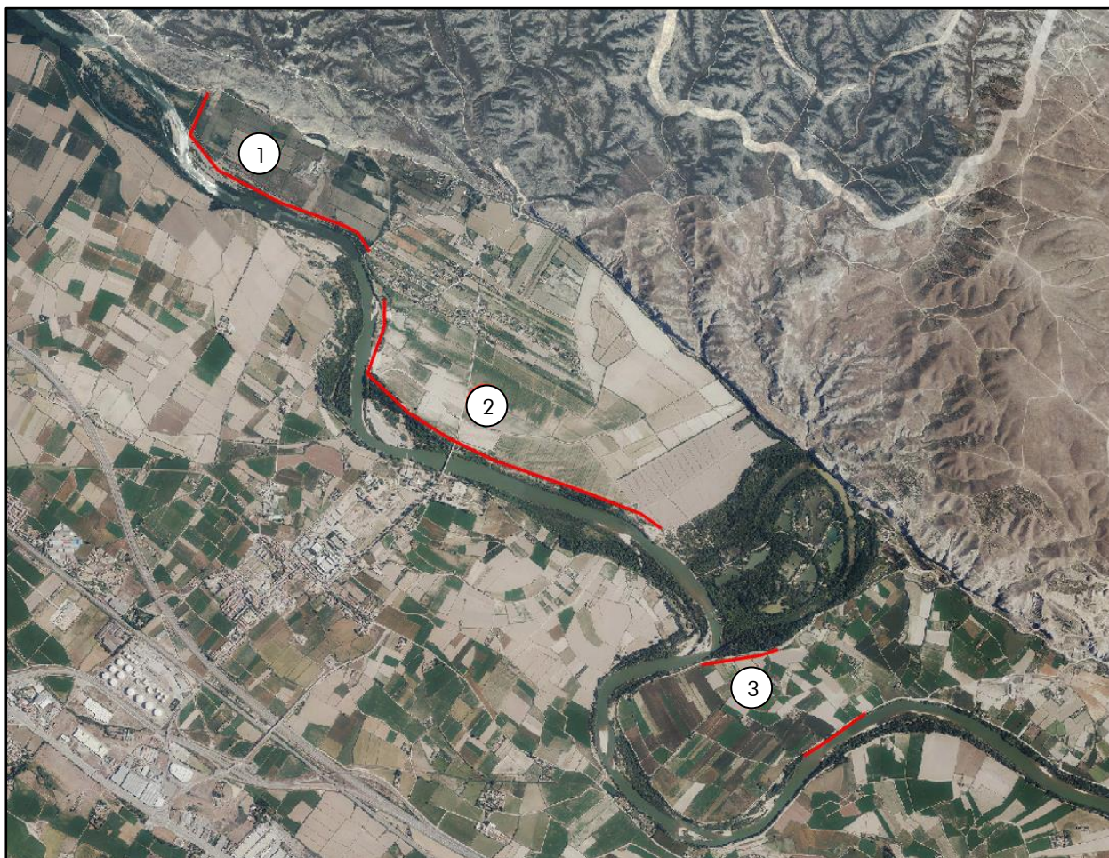
Figura 15. Diques que producen obstáculos al flujo principal: ① defensa de la huerta del soto Viejo, ② defensa de la huerta de Alfoceda y ③ dique del meandro de El Soto.
