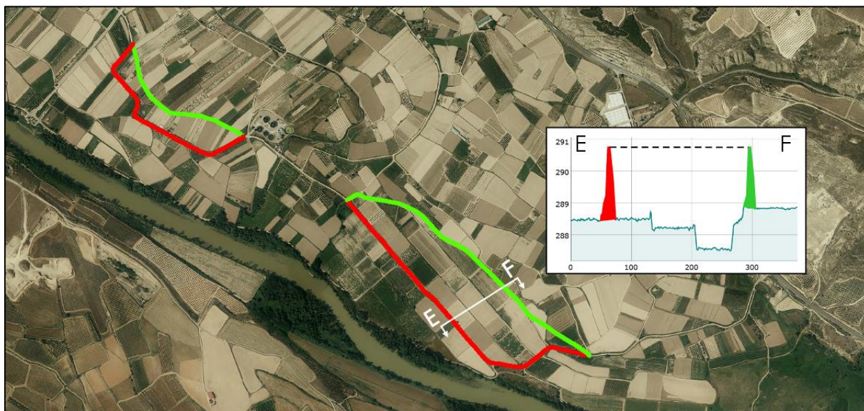
Figura 12. Propuesta de retranqueo del motarrón, en rojo tramos a eliminar y en verde nuevos tramos a construir (elaboración propia).
