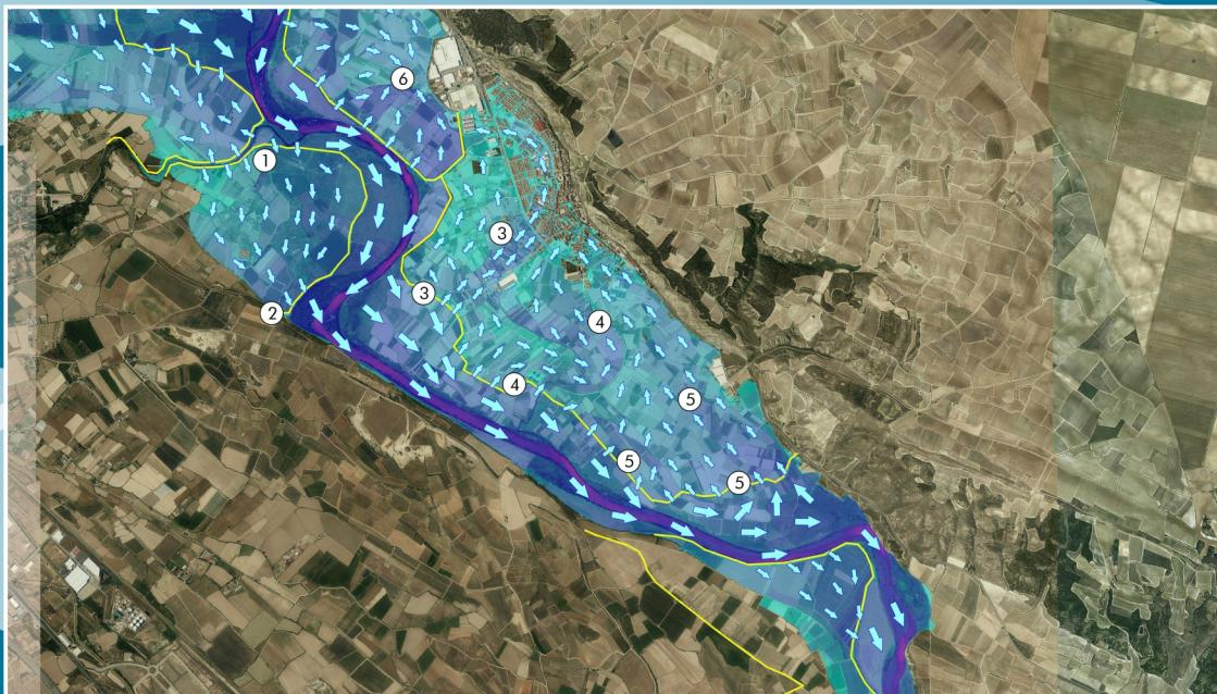
Cuando coinciden avenidas en los ríos Ebro y Ega, la actual canalización no puede absorber los caudales y se produce el desbordamiento de los diques.
