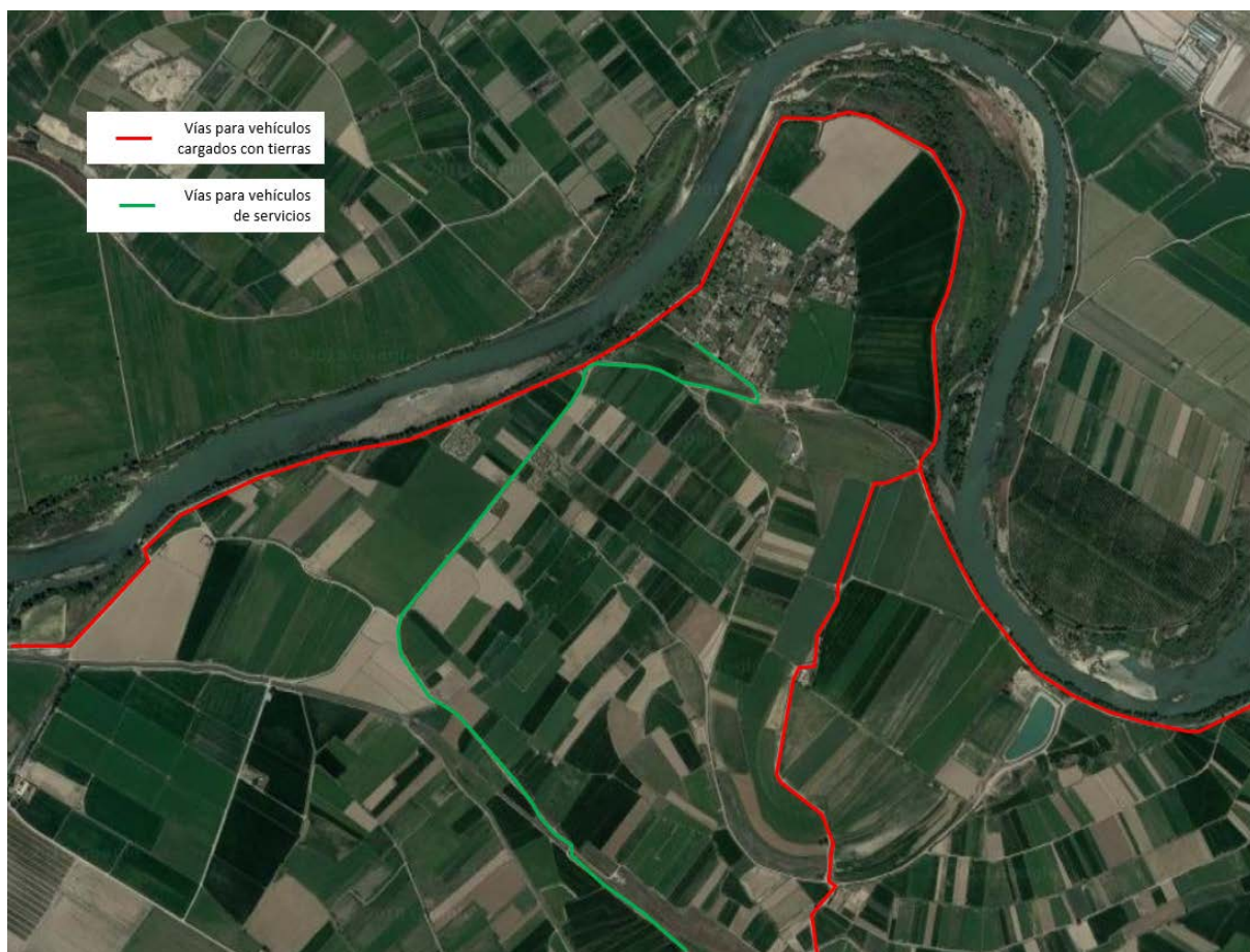
Fig. 7: Vías de para vehículos de servicios y para transporte de tierras
