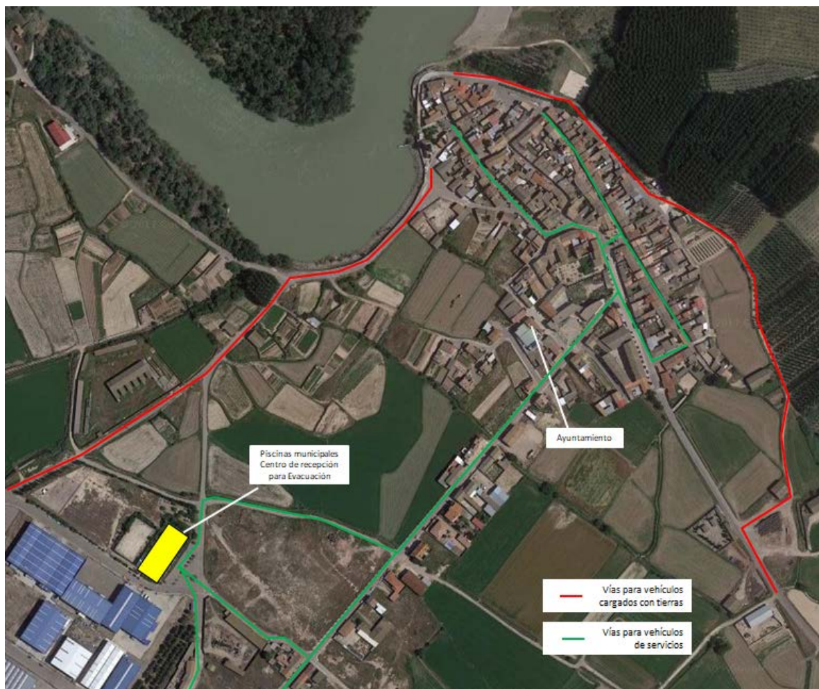
Fig. 7: Vías de para vehículos de servicios y para transporte de tierras
