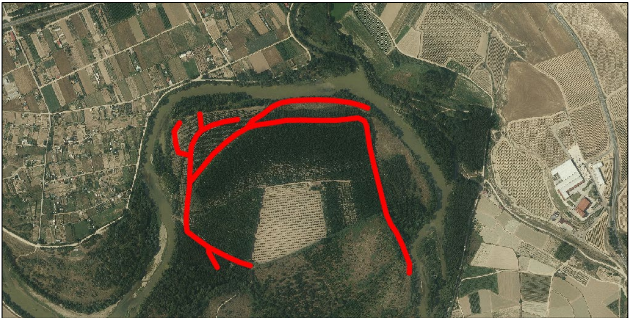
Figura 12. Alternativa de actuación en la zona de confluencia, diques a rebajar o eliminar, en rojo (elaboración propia).
