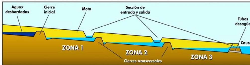
ACCIÓN B2 - FIGURA 7. ESQUEMA DE LLENADO DE ZAFL
