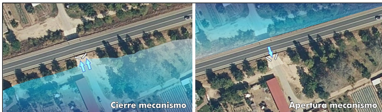
Figura 15. Mecanismo de cierre en los pasos bajo la variante (elaboración propia).
