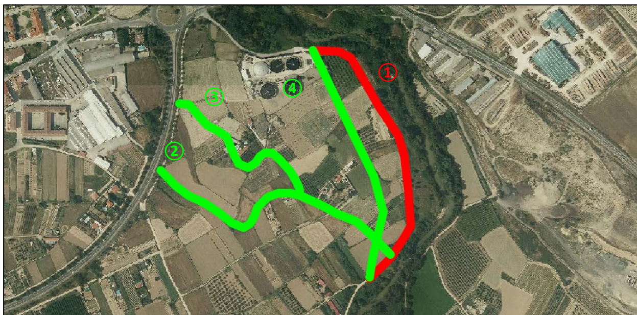
Figura 13. Alternativas de retranqueo del dique en el estrechamiento del río Ega. En rojo el dique a eliminar ① y en verde las diferentes alternativas estudiadas para el nuevo dique, ②, ③ y ④ (elaboración propia).
