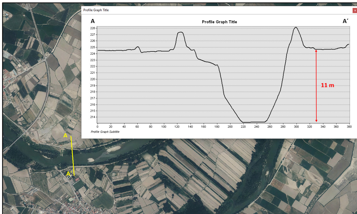
Figura 8. Perfil transversal del cauce del río Ebro entre Pradilla de Ebro y Boquiñeni, en el tramo más estrecho de la canalización (elaboración propia).
