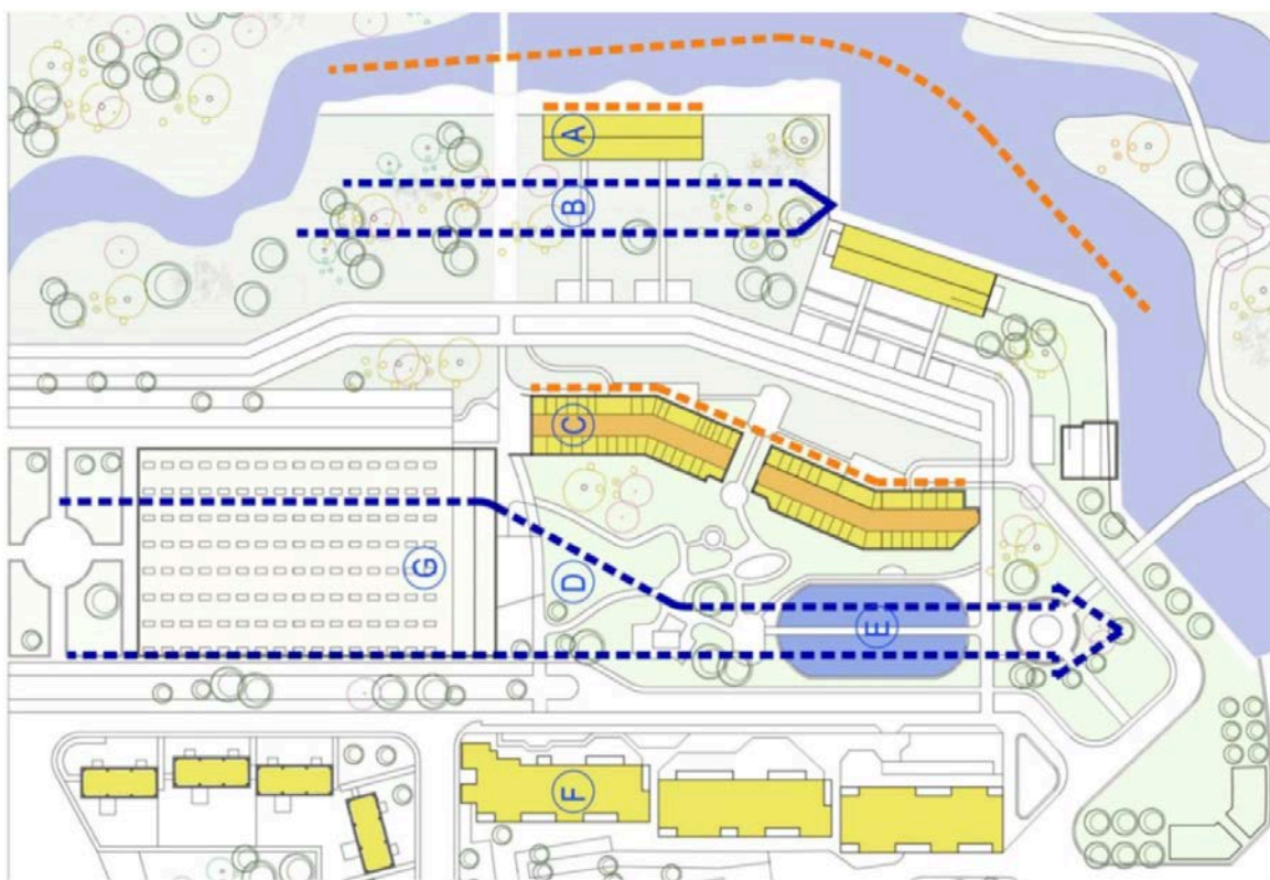
Figura 33. Esquema de "Transparencia Hidráulica" y tipologías de edificación y espacios públicos en el proyecto urbanístico de Matra (Romorantin-Lathenay).
