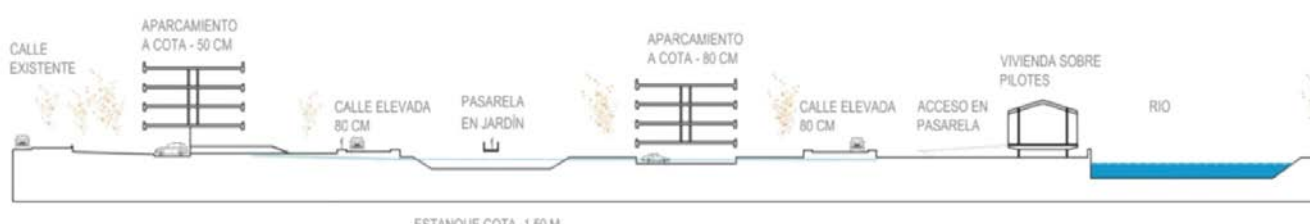
Figura 32. Sección transversal de viviendas/espacios públicos ilustrando el concepto de "Transparencia Hidráulica".
